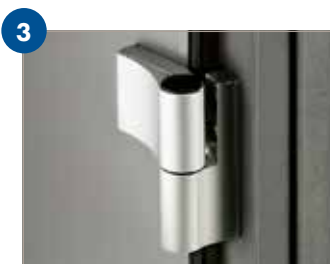
3 BÄNDER (3 STÜCK) *) Aufliegende zweiteilige Türbänder, dreidimensional verstellbar, in EV1, Trag- kraft bis 160 kg Flügelgewicht pro Band
