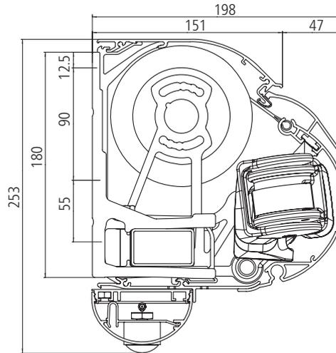
**K2000 mit Getriebe (mit Rückwand)**
